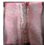
Figura 4. Probeta fabricada con proceso MIG Fuente: Propia
